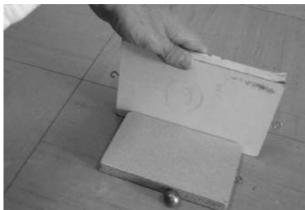
Figura 4. Montaje experimental, donde aparece la ubicación del trozo de madera, de la bolita de acero, y del objeto para impulsarla, que es sostenido por una mano.
